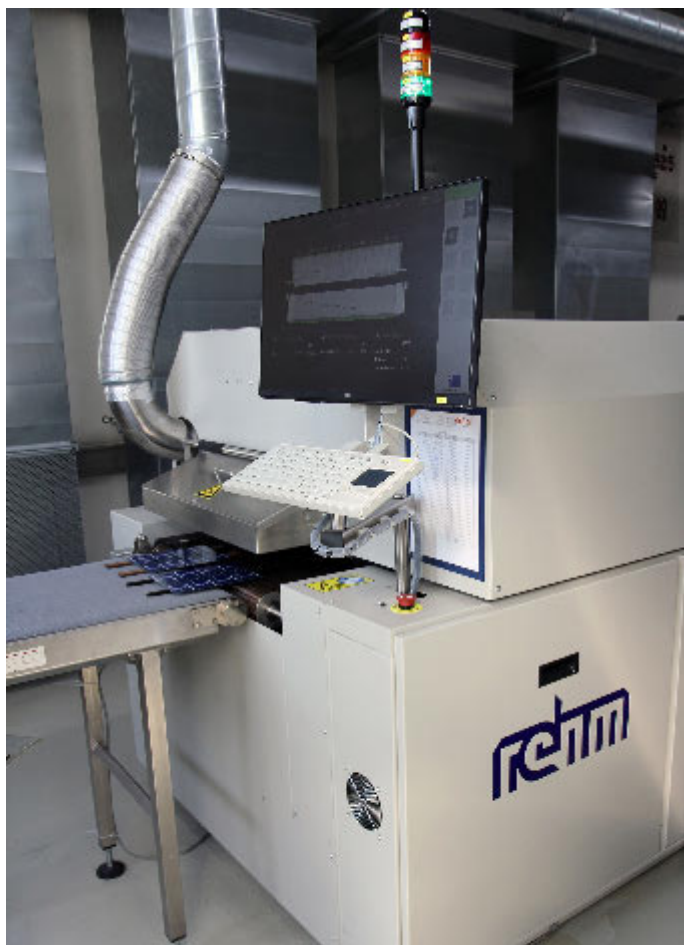
Die VisionXC eignet sich mit ihrer Kompaktheit und der Möglichkeit, unter Stickstoff zu löten, optimal für die Anforderungen von elfab.
