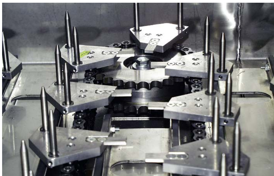
Abb. 5: Warenträgertransport der Mäanderanlage RDS 45000
