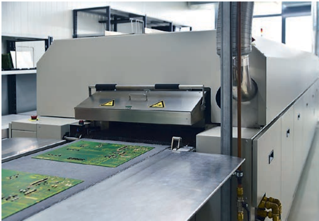
Die Vision XC eignet sich mit ihrer Kompaktheit und der Möglichkeit, unter Stickstoff zu löten, optimal für die Anforderungen von Elfab.
