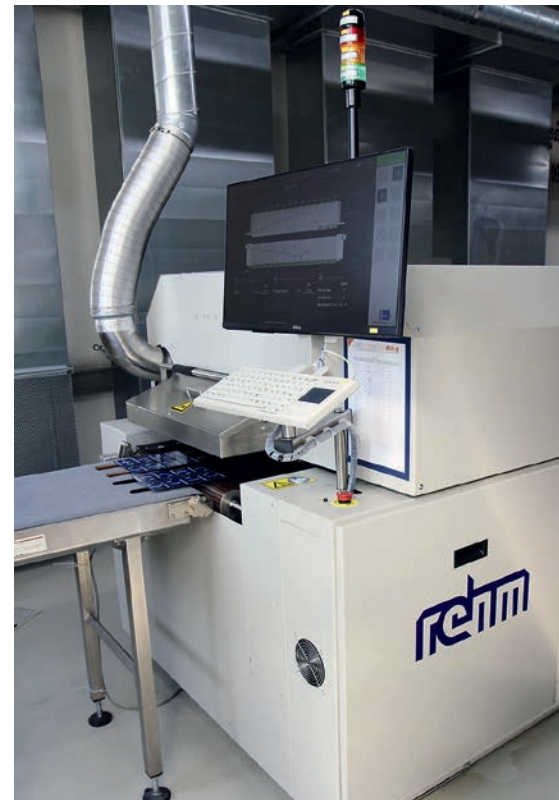
Die Schweizer Firma Elfab produziert auf einem Konvektionslötssystem von Rehm Thermal Systems für unterschiedliche Kunden hochwertige Elektronik.
