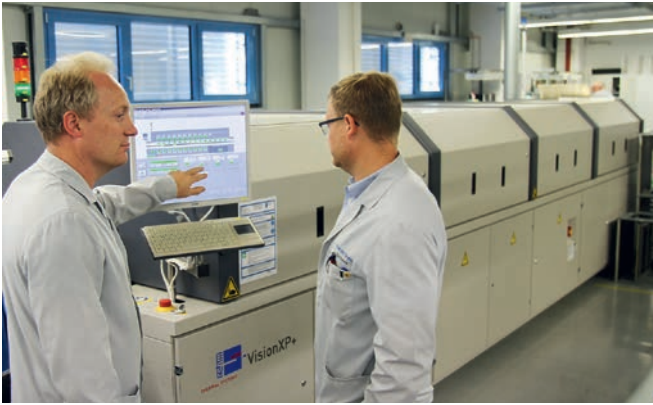
Die Tonfunk-Experten Denny Bartels (l.) und Dennis Sett sind von der Vision XP+ von Rehm überzeugt, da die Reflow-Lötanlage durch eine präzise Profilierung exakt wiederholbare Temperaturprofile ermöglicht.
