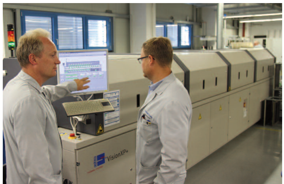
Denny Bartels (li., Leiter Arbeitsvorbereitung bei Tonfunk) und Dennis Sett (re., Leiter Technik bei Tonfunk) vor der VisionXP+ in der Produktionshalle des Ermslebener Unternehmens. Konvektionslöten ist für Tonfunk vor allem deswegen interessant, da verschiedene Einflussparameter kombiniert werden können.
