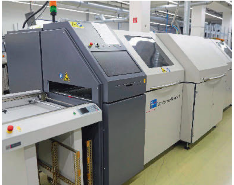
Die Rehm Condenso XS Smart Kondensationslötanlage bei Hannusch.
