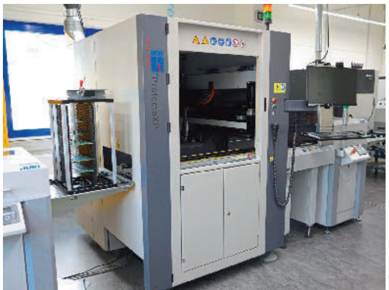
Mit der ProtectoXP werden elektronische Baugruppen vor aggressiven Umwelteinflüssen geschützt.
