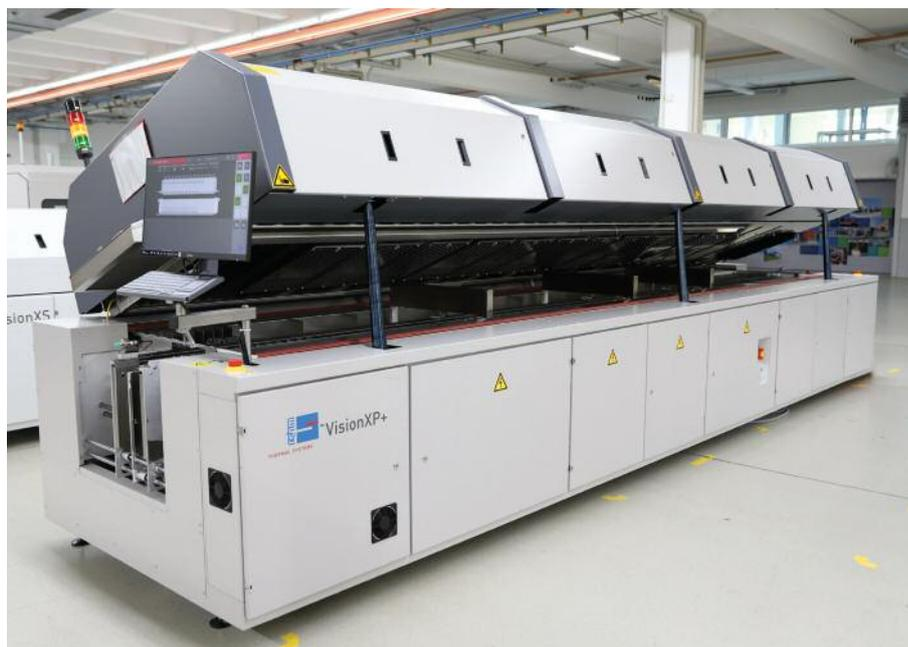
Reflow-Konvektionslötsystem VisionXP+ der neuesten Generation
