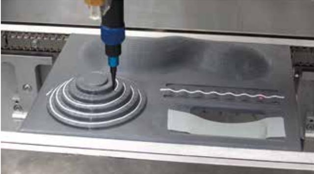
Präziser Materialauftrag bei komplexen Geometrien
