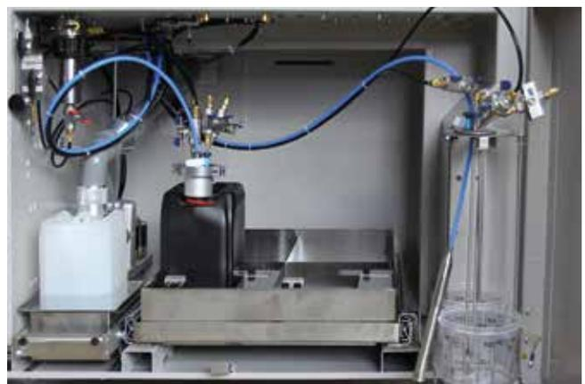
Leicht zugängliche Lackbevorratung an der Anlagenrückseite
